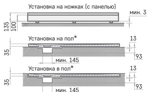
\* между поддоном и поверхностью обязательно должен быть полипропилен толщиной 3 мм
