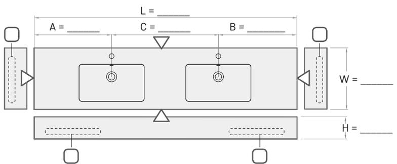
\* Полотенцедержатель возможен только с панелью H = 150 и его расположение зависит от конфигурации чаши
